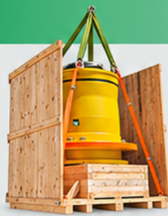
Trincaje de maquinaria
